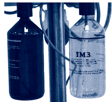
Fig.5 - N'utilisez que la bouteille ambrée de CLS ou de l'eau distillée (bouteille claire) lors de l'utilisation de l'unité de détartrage 42-12
