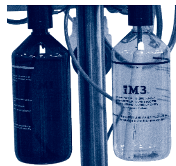
Fig.5 - Use SOLO la botella ámbar de CLS o agua destilada (botella transparente) cuando use la unidad de escalado 42-12
