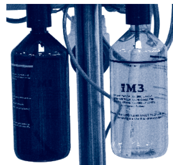
Obr.5 - Při používání jednotky scaleru 42-12 používejte POUZE jantárovou láhev CLS nebo destilovanou vodu (čirá láhev)
