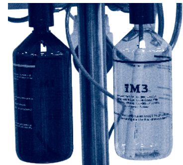
Abb. 5 - Verwenden Sie beim Gebrauch des 42-12 Scaler-Geräts NUR die CLS-Bernsteinflasche oder destilliertes Wasser (Klarsichtflasche).
